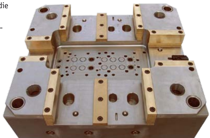
Formplatte mit Gleiteinsätzen aus ALBROMET 200
